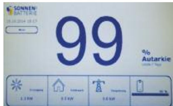
Touchdisplay der Sonnenbatterie mit bis zu 99 % Autarkiegrad bei Ökohaushaus
