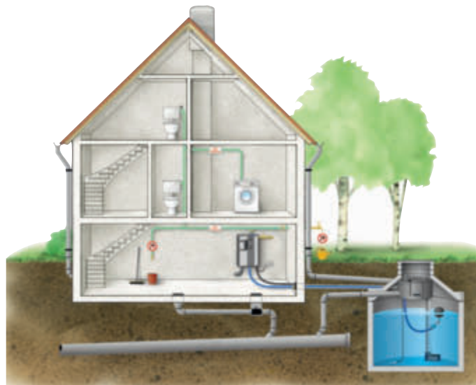
Herzstück der Anlage ist eine Regenwasserzisterne mit einem Fassungsvermögen von 6.000 Litern.
