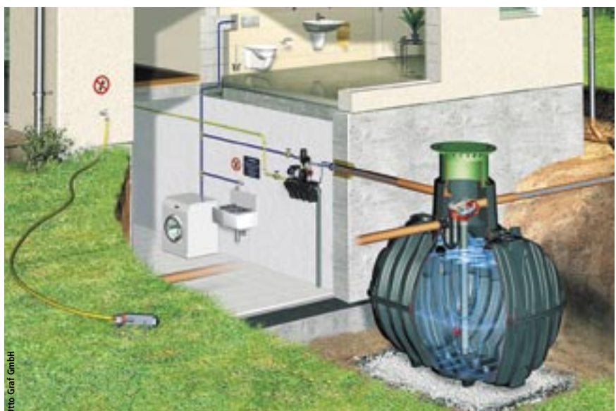
Regenwassernutzung ist Lowtech: bewusst einfach konstruiert, verlässlich und langlebig.
